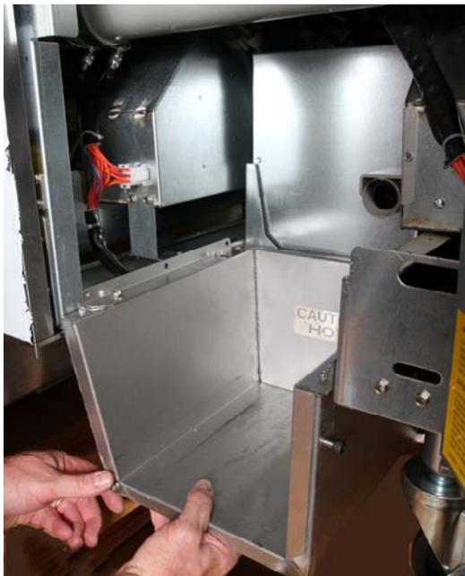
**Figura 2:** Posicione el fundidor.
